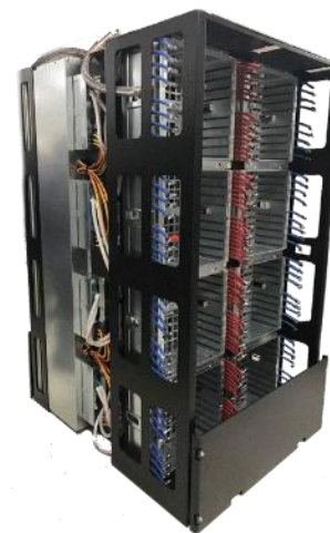
100% ファンレス直接水冷 (DLC)
