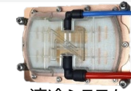
液冷システム (ダイレクトチップ冷却)
